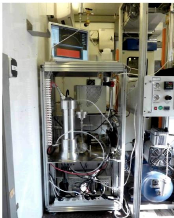
Імпактор для вимірювання UFP, Тип SMPS-IIT: Реєструє розмір і кількість частинок.
