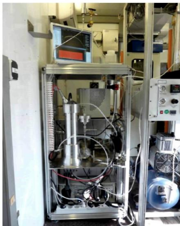
Імпактор для вимірювання UFP, Тип SMPS-IfT: Реєструє розмір і кількість частинок.
